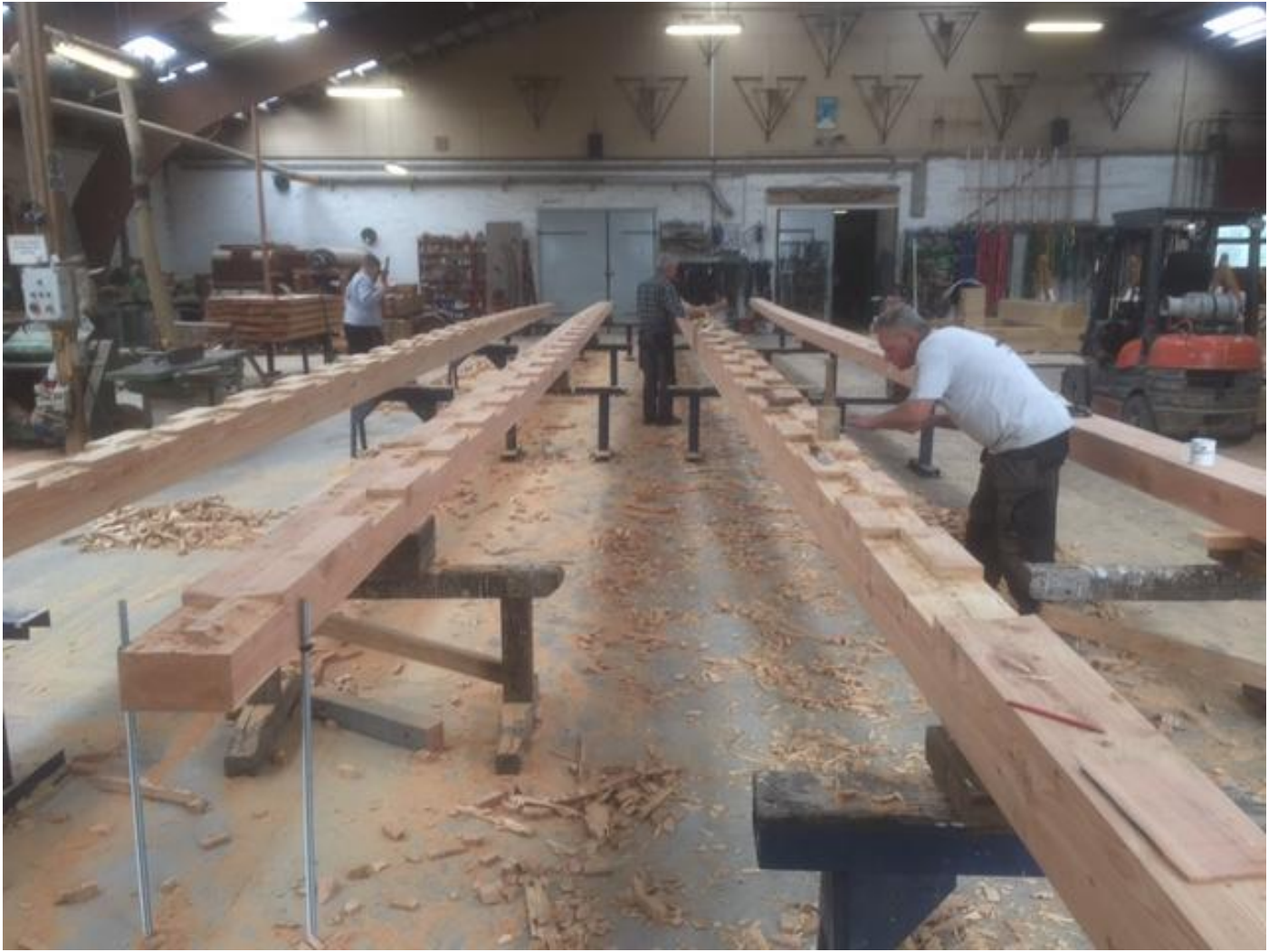
Vingene er ved at tage form der skæres ud til vingeklapperne
