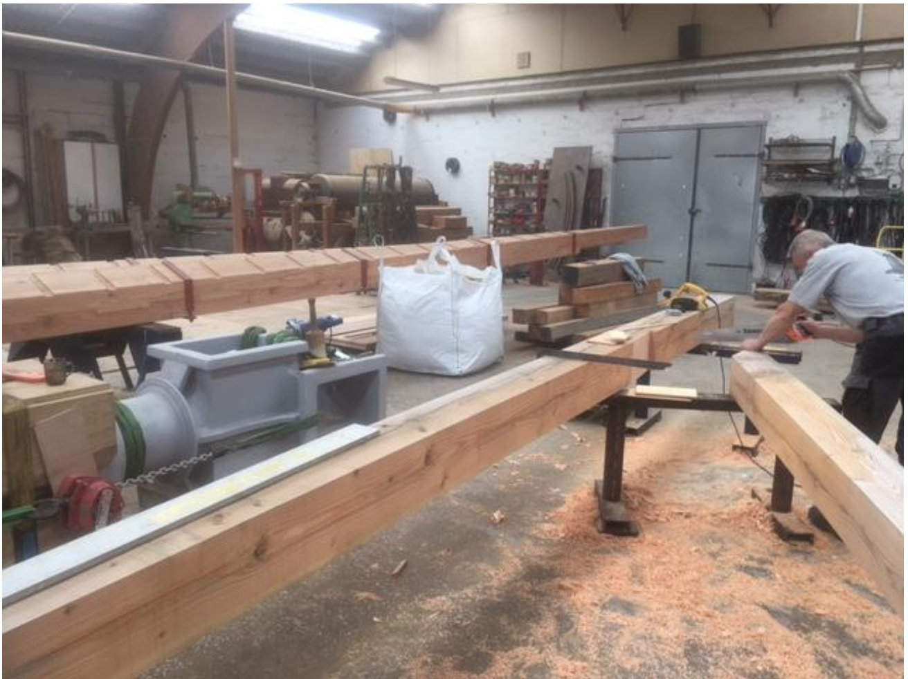
Bagerst prøvesamling af vingerne inden arbejdet med klapperne I forgrunden arbejdet med tømmeret til Vindrosen.
