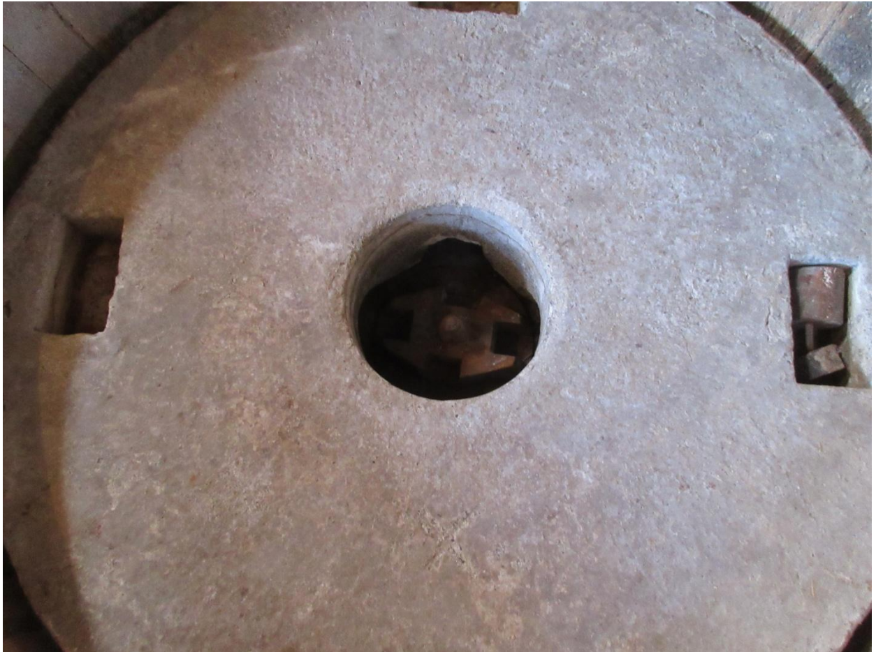
Fotograferet lige ovenfra ses i midten den aksel der understøttes i broen nede på Broloftet og som holder den øverst kværn og som kan justeres i højden op/ned.
