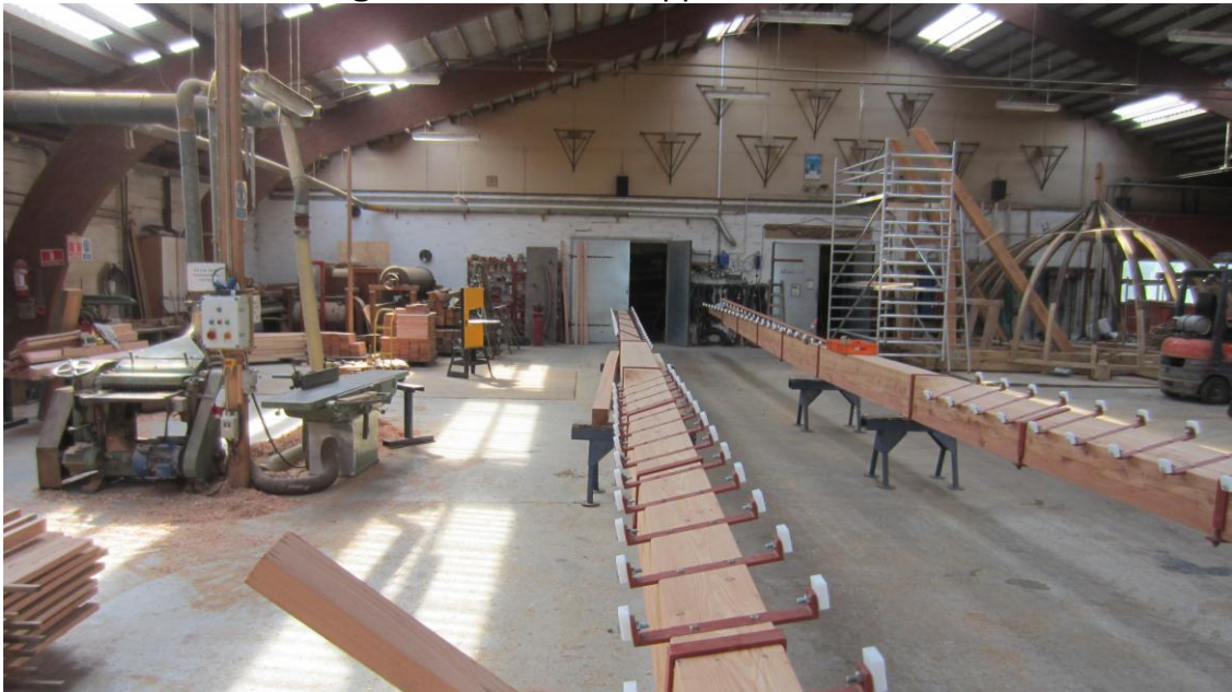
Bemærk at de to vingestykker på samme vinge skråner modsat hinanden. I enden her op imod skråner de ned mod venstre. I modsat ende skråner de mod højre.
