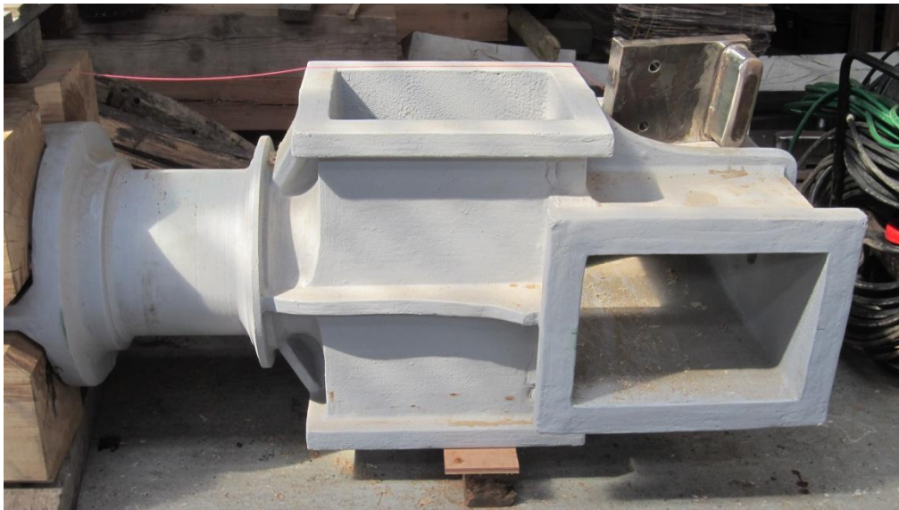
På gulvet ligger den ca. 5-6 meter lange Vingeaksel, som placeres inde i møllehatten og som skal bære de to sæt møllevinger.
