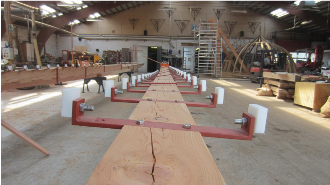
Imens er man gået i gang med Klapperne. Her ses en prøvesamling hvor de beslag som skal holde klapperne er stemt ud i træet.
