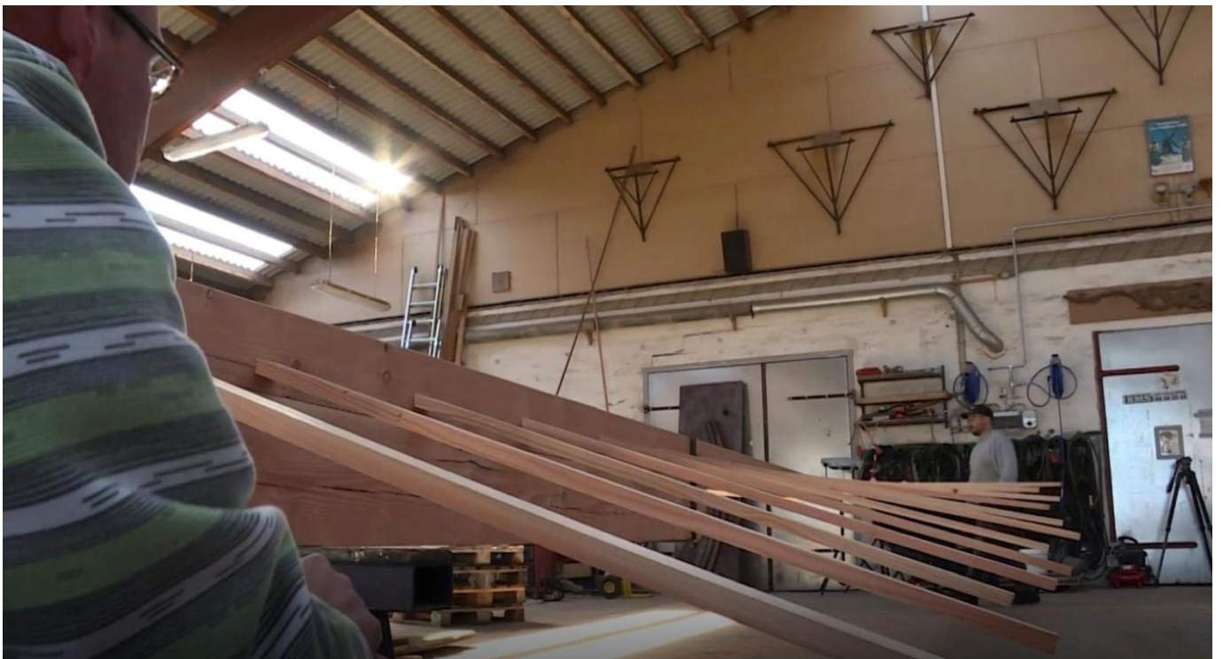
Her ses det færdige skelet som Klapperne skal bygges op omkring på de to vingearme Bemærk de lane stokke som sider i en bølglignende bevægelse
