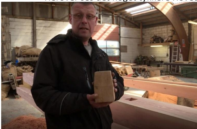
De hårde egeklodser som bruges til nagler kaldes Brosten
