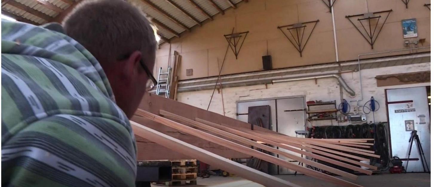
At hullerne laves mere og mere skrå - er det der giver Vingen sin mest effektive profil og som Poul la Cour i 1890`erne fandt frem til.
