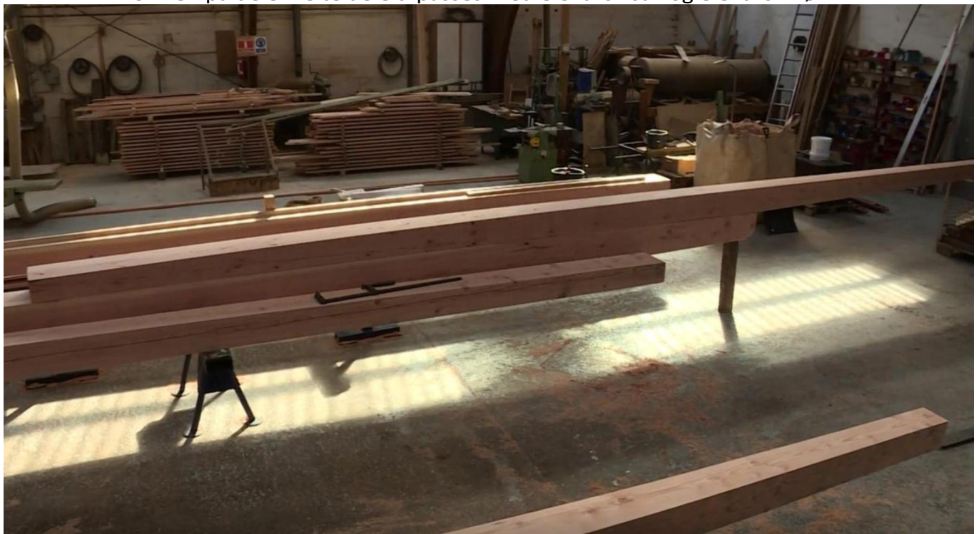
En af to færdige møllelevinger består af tre dele: Nederst et Hovedstykke/Bryststykke/Midterstykke På det nagles to forlængere – én i hver ende med ca 1 meters mellemrum på midten Herover ses det noget tykkere Hovedstykke hvorpå den højre forlænger er påsat
