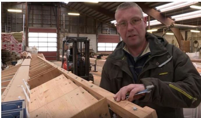
Her er de korte klapper monteret på den ene side af vingen
