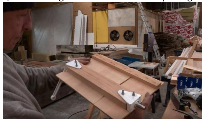
Sådan! 15 små klapper som her + 15 store ca. dobbelt så lange I alt 30 klapper pr. vinge x 4
