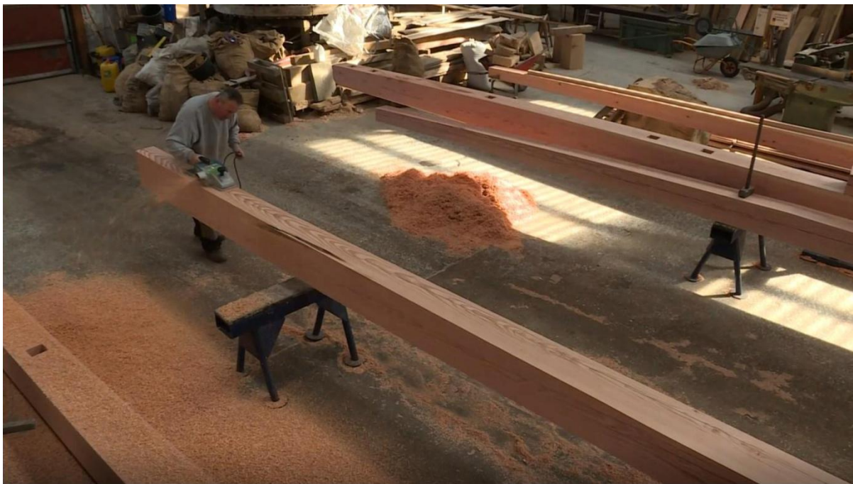
Når træet er tørt – saves det rått til og kommer ind i maskinhallen/snedkeriet Formen på de enkelte dele tilpasses med elektrisk sav og elektrisk høvl
