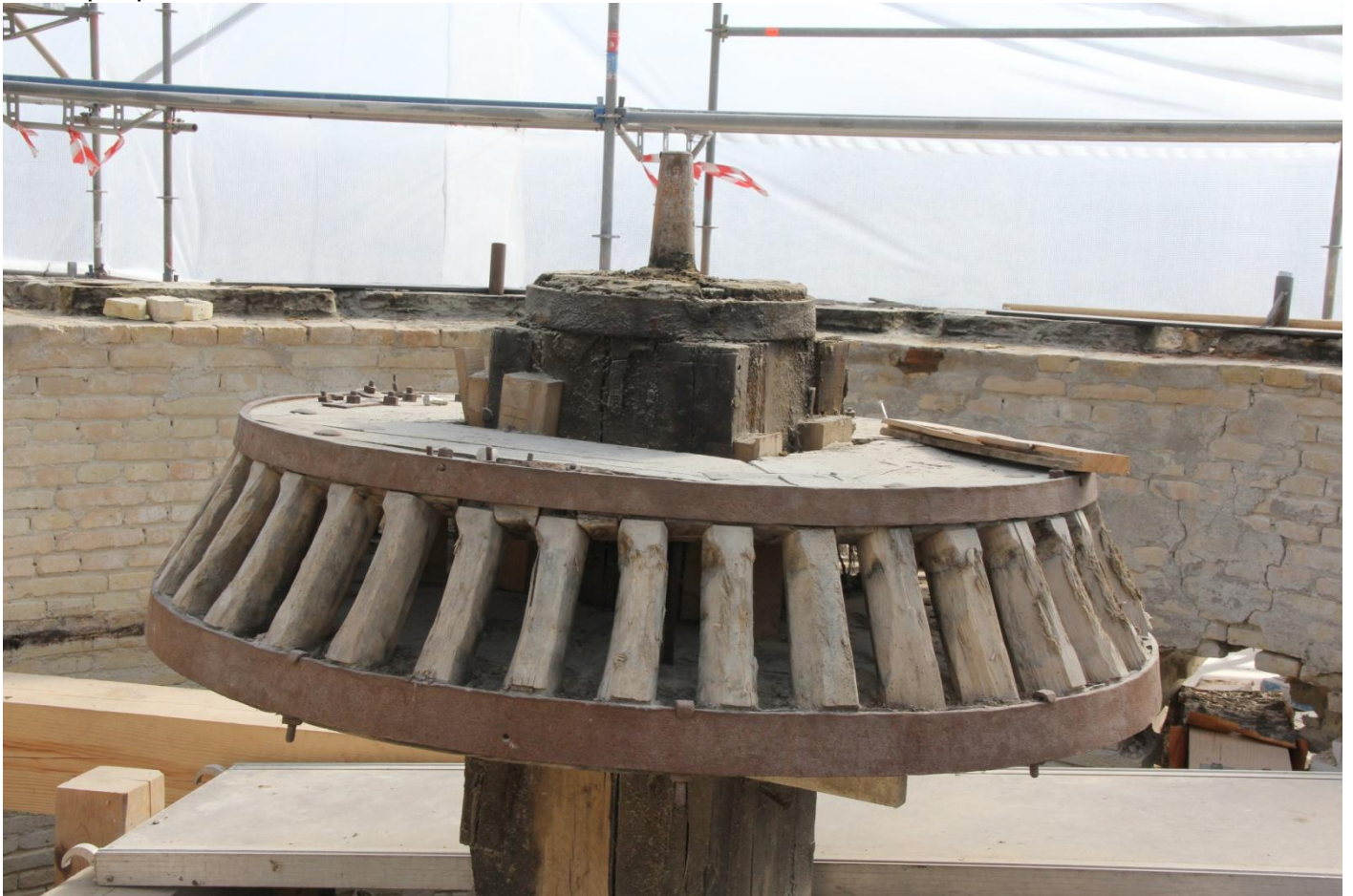
Også "Kronrevet" øverst på "Kongevellen" skal renoveres, da møllehatten har trukket det lidt skæve krondrev forkert og dermed har slidt de mange stokke i dette stokkehjul.
