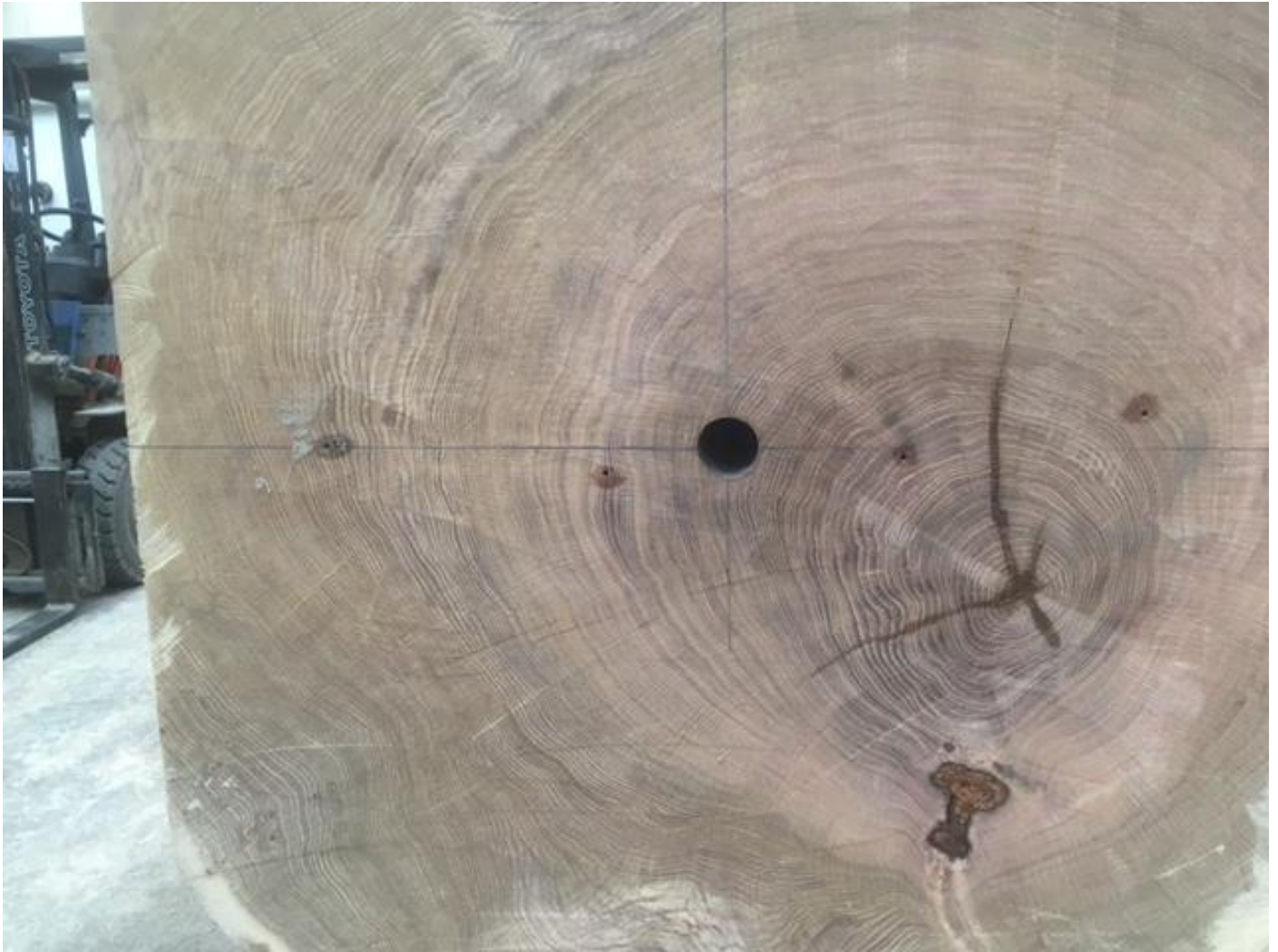
Krydset er slået og hullet som han borer fra centrum igennem hele Vingeakslen (4 meter) Mon der er hul igennem de 4 meter egetræ??
