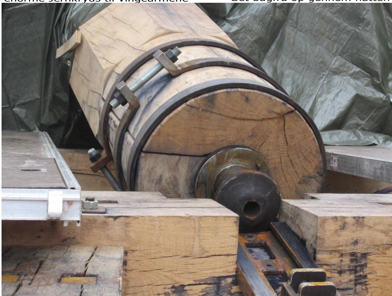
Den tonstunge Vingeaksel som Jernhovedet er fæstnet i og som ligger i to lejer
