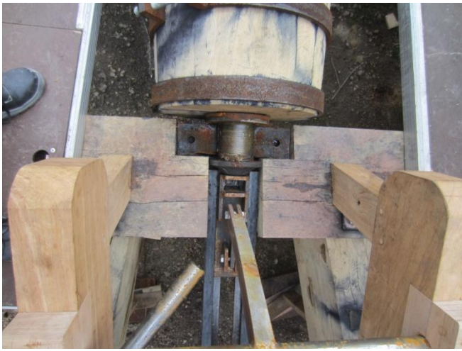
Bagenden af Vingeakslen hviler i et søleleje
