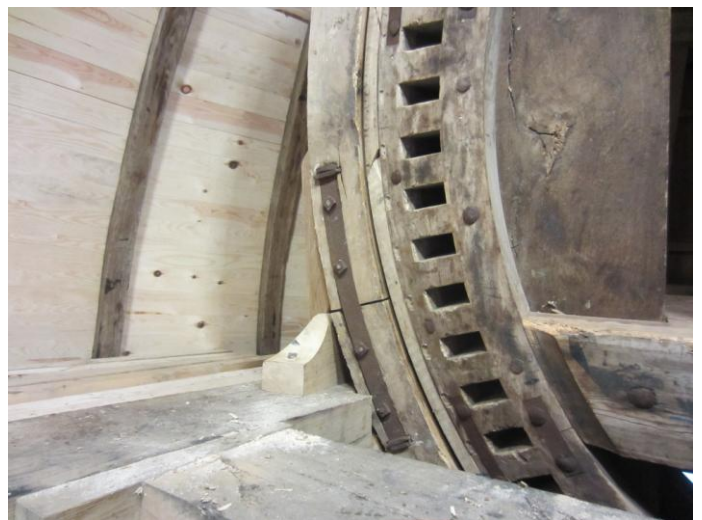
Her ses tydeligt "Persen" eller Møllens bremse – Remmen af egesveller der kan spændes ind og trykke på hjulet
