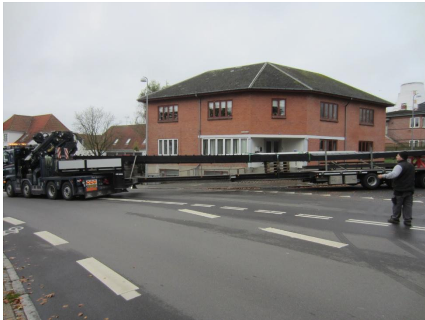
Blokvognen forrest kan dreje med bagendens hjulsæt
