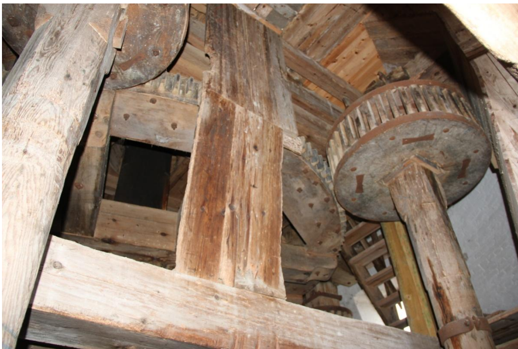
Bagerst Vandret en del af det meget store Stjernehjul i Christiansmøllen. Herpå er sat 4 mindre stokhjul til at trække de forskellige maskiner.
