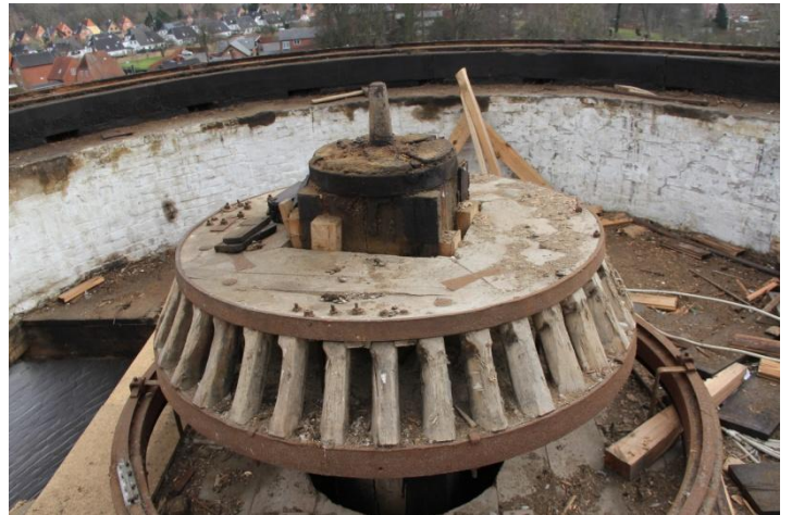
Et kig ned i Møllen. Øverst på Kongevellen sidder Krondevet
