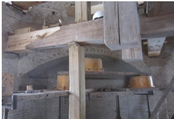
Vi er på kværnloftet. Herover ses det nederste af kongevellen og de vanskelige arbejdsforhold er synliggjort.
